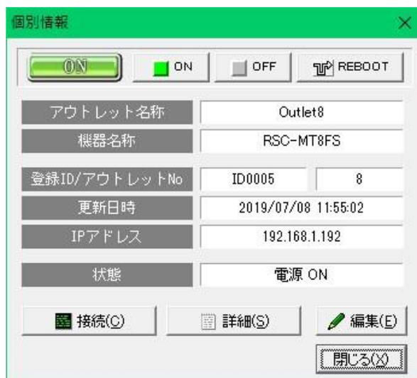
[接続] : クリックすると「機器情報 登録/編集-接続」(p.24)の「接続方式」で設定した内容で接続されます。接続後の設定、制御は、各機器の取扱説明書を参照してください。
